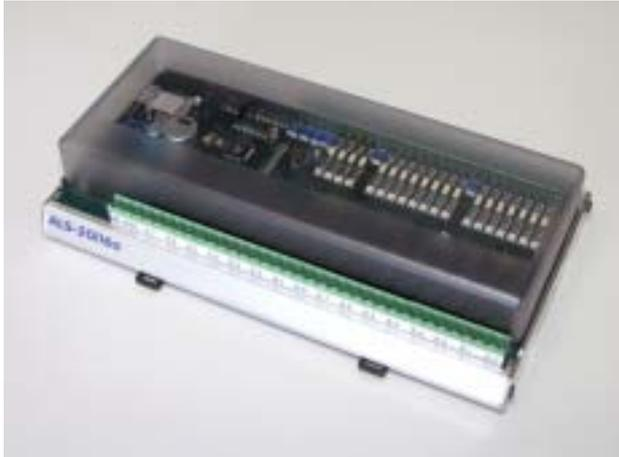
Scheda SLAVE di espansione per logiche *Detail*® con 20 ingressi (4 con opzione contatori veloci) e 16 uscite
