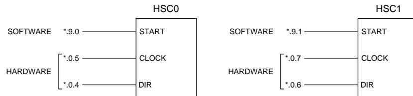
Mediante i 4 ingressi in morsetteria è possibile controllare il conteggio e la direzione dei due contatori; in particolare gli ingressi \*.0.4 ed \*.2.6 costituiscono il segnale di direzione (DIR) rispettivamente del contatore HSC0 e HSC1: un valore OFF (led spento) determina un incremento del valore corrente in modo sincrono con l'ingresso di CLOCK, mentre un valore ON (led acceso) determina un decremento.
