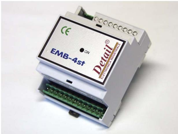
Scheda SLAVE di espansione per logiche *Detail*® con 4 ingressi per sonda termica
