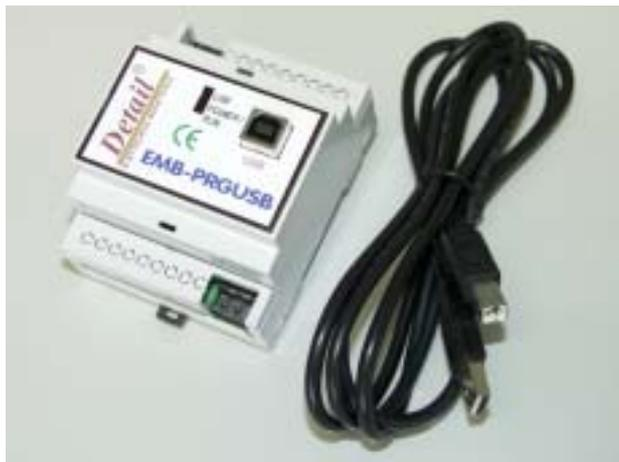
Interfaccia di programmazione per PLC *Detail*® con ingresso USB
