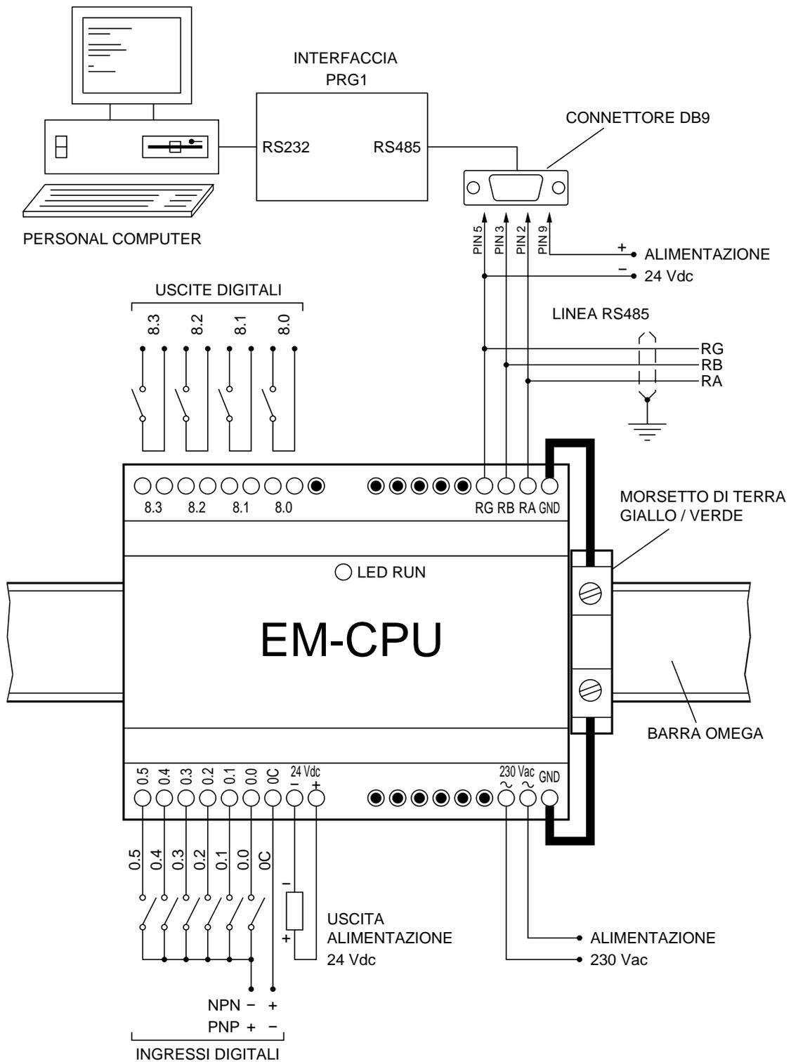
Schema di collegamento EM-CPU
